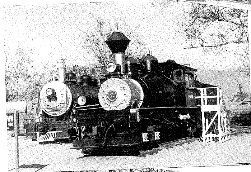
Locomotiva «Shay» a carrelli per percorsi montani con curve di piccolo raggio. Il motore, disposto verticalmente sul lato destro trasmette il movimento ai carrelli per mezzo di giunti cardanici.
