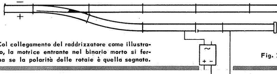
Col collegamento del raddrizzatore come illustrato, la motrice entrante nel binario morto si ferma se la polarità delle rotaie è quella segnata.
