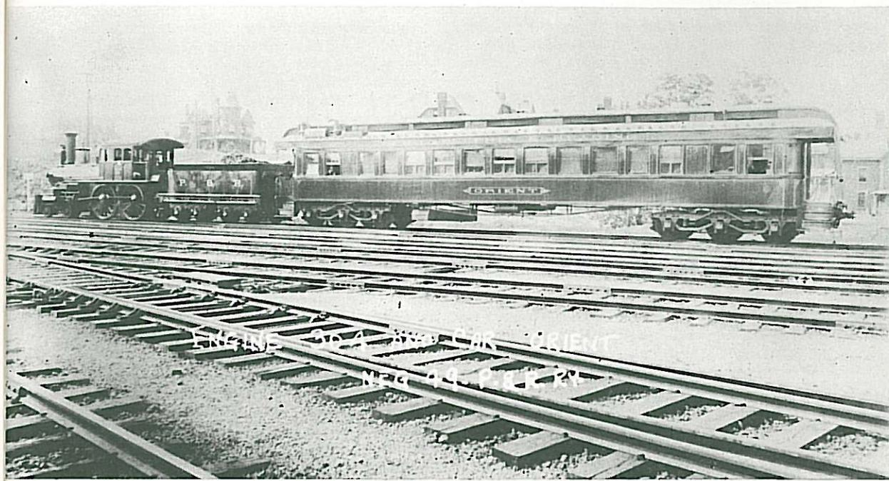
Fig. 1 Locomotiva 4-4-0 (American) N. 304 della Philadelphia and Reading in manovra con una vettura del tipo «business car». Foto scattata nel lontano 1885. (Foto Orsini)
