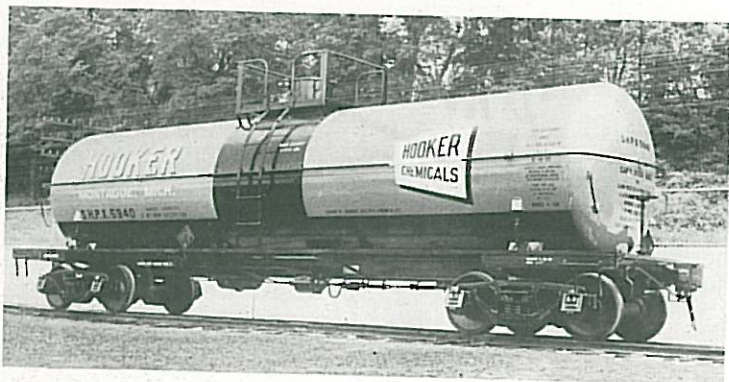
Fig. 15 Prototipo del «Tank car» riprodotto fedel- mente dalla Rivarossi . Carro serbatoio per il trasporto di cloro, di proprietà della «Hoo- ker Chemical Plastic».
