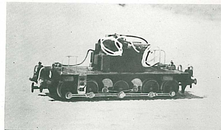
Fig. 1 Il telaio del locomotore F.S. GR E 550 in fase di realizzazione.
