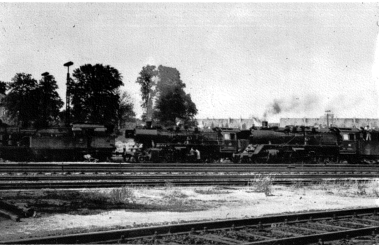
Fig. 6 e 7 Queste due fotografie sono state scattate durante la visita dei congressisti MOROP al deposito locomotive di Lubecca. Si intravedono, su ambedue, alcune locomotive in fase di manovra delle Deutsche Bundesbahn del tipo BR 50, da cui è poi derivato il tipo BR 52 e successivamente la locomotiva BR 42 avente le medesime caratteristiche del gruppo 50 ma più semplificata come dettagli costruttivi. Il modello della BR 42, in scatola di montaggio Tren-Hobby 11331, è stato recentemente presentato dalla Rivarossi su tutti i mercati del mondo.
