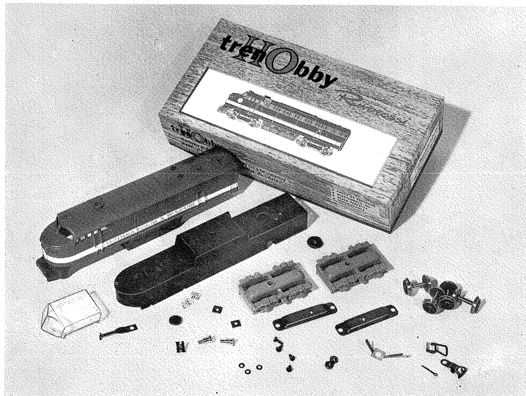
Fig. 1 Presentiamo i vari pezzi scomposti della locomotiva «serie TrenHOby» 11888.
