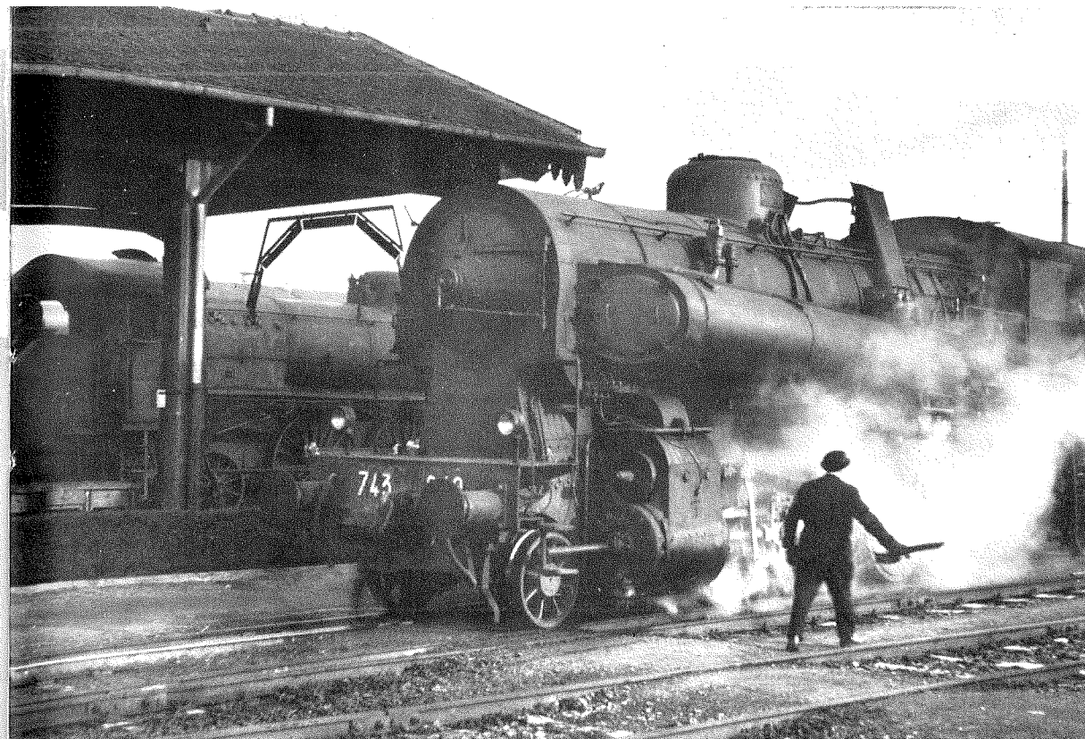
Il Sig. Giovanni Denti di Cremona ha fotografato, tempo fa, al Deposito di Cremona, due locomotive a vapore delle F.S. In alto vediamo una 743, con preriscaldatori Franco Crosti, in fase di manovra (la GR 743 deriva dal gruppo 740 di cui la Rivarossi ha posto in commercio i modelli 1113 e 11113 in scatola di montaggio TrenHobby). In basso, invece, si nota una locomotiva GR 685 fotografata con un'ottima inquadratura che la mette in particolare evidenza.
