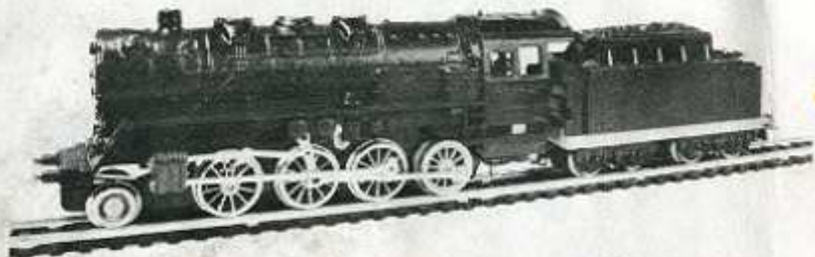
Art. 3001 - 9/12 Volts - L. 1600. Locomotiva 4 assi - più tender 3 assi - per traino convogli passeggeri e merci - funziona su circuiti diametro cm. 72 ed oltre - lunghez- za totale cm. 24,2.
