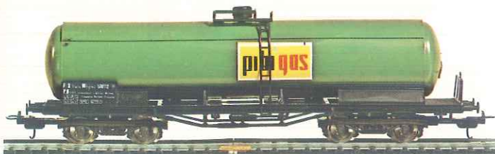
Carro cisterna per il trasporto propano e butano delle FF.SS.
