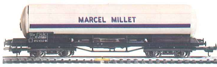
Carro cisterna della S.N.C.F. per il trasporto di ammoniaca
