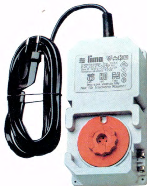
2054 Transformer, Features: Power 4,2 V.A. Mains voltage AC. 110 or 220 Volt. Output 4-12 Volt DC at 0,35 A.
