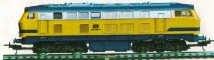
1632 L Diesellokomotive der DB. Baureihe 218. (alt. V 160) für schwere Reise- und Güterzüge in den Farben der DB türkis/beige. LUP 184 mm.
