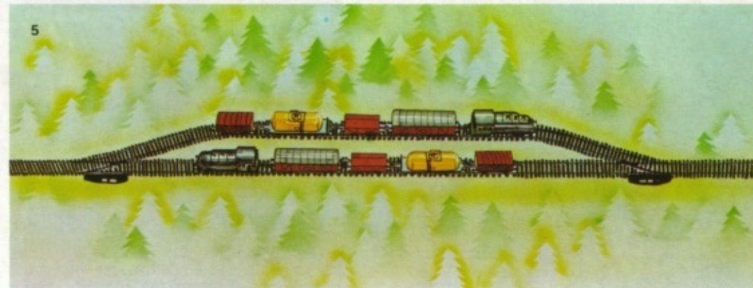
Abb. 6 Vorteil der Weiche: Die Gleisverdoppelung an bestimmten Punkten der Strecke ermöglichte es und ermöglicht es auch heute noch, daß ein schnellerer Zug einen langsameren überholt, der in dieselbe Richtung fährt. Im abgebildeten Fall befinden sich zwei Züge in der "Überholphase".
