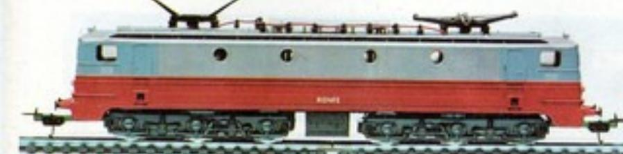
**8062L** Locomotiva elettrica Co'-Co' serie 7600 delle ferrovie spagnole R.E.N.F.E. mm. 217.
