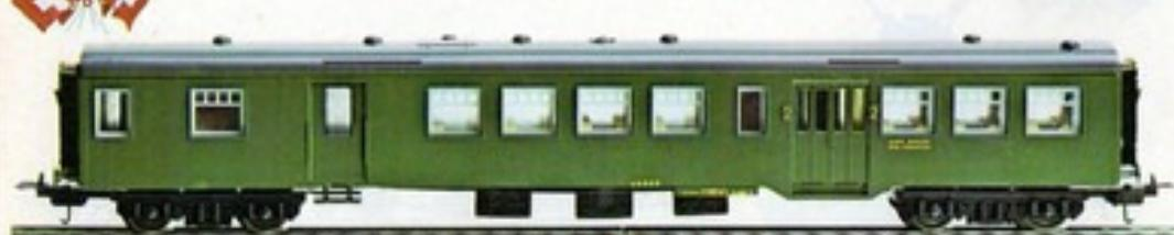
**9303** Carrozza mista di bagagliaio e 2<sup>a</sup> classe delle ferrovie belghe S.N.C.B. tipo M2 mm. 253.
