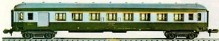
330 Carrozza mista di bagagliaio e di 1<sup>o</sup> classe serie A7D delle
