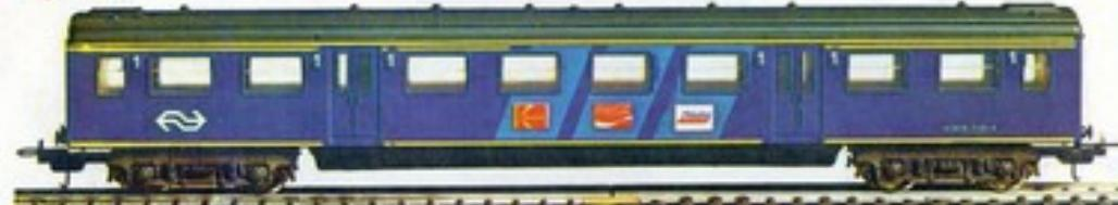
9109 Carrozza di 1<sup>a</sup> classe serie A 6500 delle ferrovie olandesi N.S. mm. 253.
