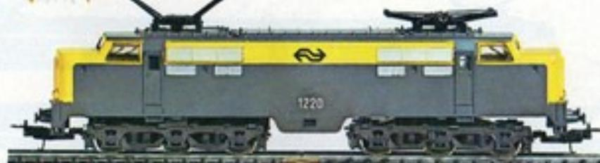
**8024L** Locomotiva elettrica serie 1200 delle ferrovie olandesi N.S. mm. 204.
