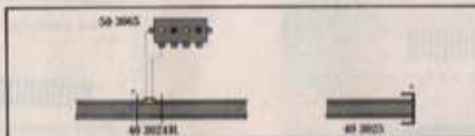
Rotole isolate per binario tronco: nel tratto compreso tra A e B, segnato più grosso nello schema, manca la corrente di alimentazione fino a quando non viene premuto il pulsante di sinistra della pulsantiera (articolo 40 3005). In questo modo la locomotiva, arrivata nel tratto senza corrente, si arresta automaticamente senza rischi di danneggiamento.
