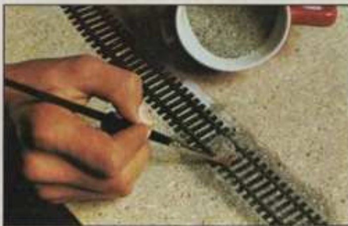
2 - spargere la valigia lungo il binario, tra le traversine e ai lati, entro le linee di delimitazione della massicciata.
