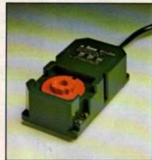
50 2056 Trasformatore per due treni. Alimentazione a 230 V. Tensione disponibile in corrente continua 0-12 V. a 0,5 A. Protezione contro i corto circuiti a diaguntore termico.
