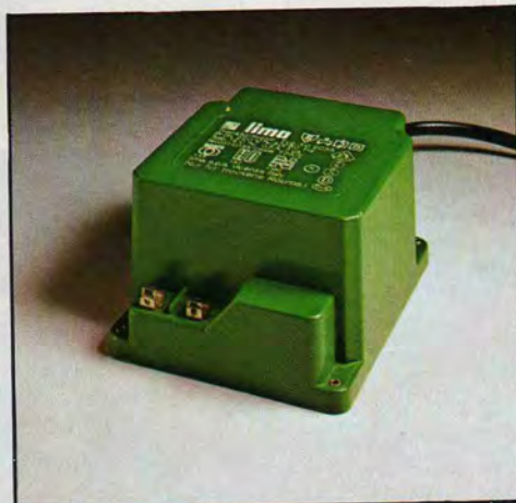
502055 Trasformatore per dispositivi elettromagnetici. Tensione di alimentazione in corrente alternata a 59-60 Hz., 220 V. Uscita 10 Volts alternata. Potenza V.A. 7.
