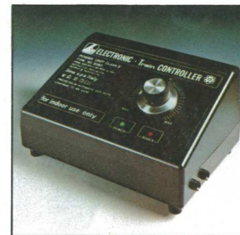
502060 Transformator für Mehrzugbetrieb; und elektr. Zubehör. Primär 220 V. Elektronische Spannungsregelung für 0-12 V. 7,5 VA für Zugbetrieb und Wechselstrom-Ausgang 14 V. 7VA für Elektro-Zubehör. Thermo-Überlastungsschutz mit LED Anzeige.
