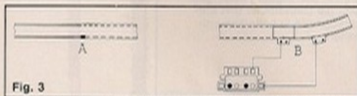
Fig. 3 Bei A ist ein Gleis isoliert worden. Das kleine Unterbrecher-Gleisstück (B) gibt den Stromkreis erst wieder frei, wenn am Schaltpult der rechte Knopf gedrückt wird. Der durchfahrende Zug bleibt sonst automatisch stehen.
