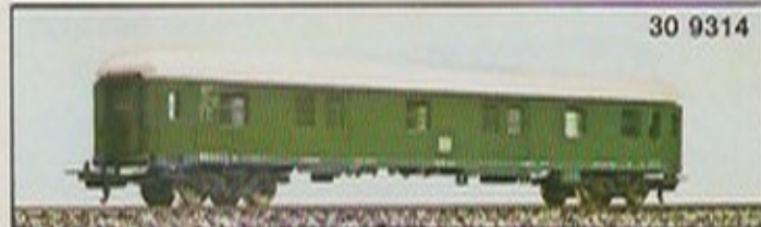
30 9314 Gepäckwagen für Schnellzüge der DB Typ Düm - LÜP 255 mm.
