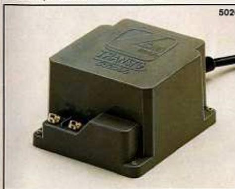
**502055** Trasformatore per dispositivi elettromagnetici. Tensione di alimentazione in corrente alternata a 50-60 Hz., 220 V. Uscita 10 Volts alternata. Potenza V.A. 7.
