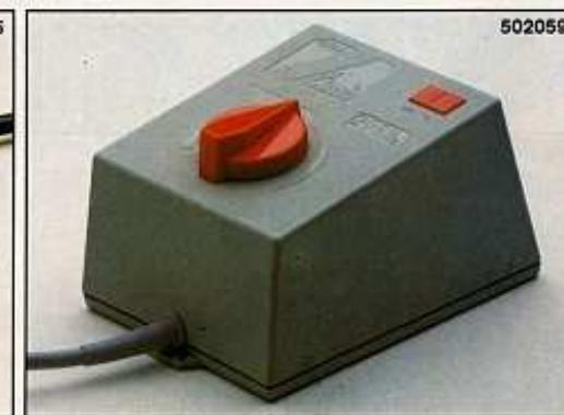
**502059** Trasformatore per due treni e scambi ed accessori elettrici. Alimentazione a 220 V. Tensione disponibile in corrente continua 0-12 V. a 1,2 A. Tensione disponibile in corrente alternata 14 V. a 1,2 A. Protezione contro i cortocircuiti a disgiuntore termico.
