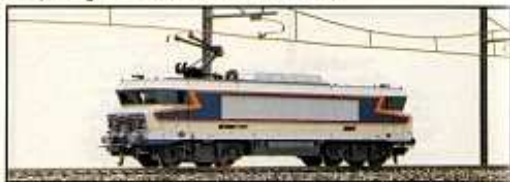
20 8154LGP Locomotiva elettrica serie 10000 delle S.N.C.F. con pantografo funzionante - L. 200 mm.
