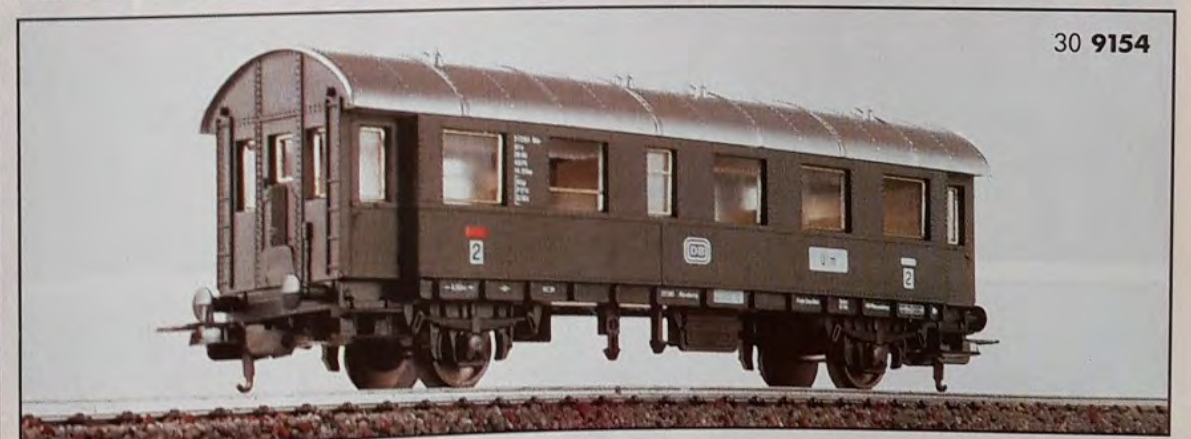
30 9154 Carrozza passeggeri di 2° classe, tipo Ble-29, delle Ferrovie Tedesche D.B. - L. 149 mm. Passenger coach, 2nd class, type Ble-29, of the DB - Length 149 mm.
