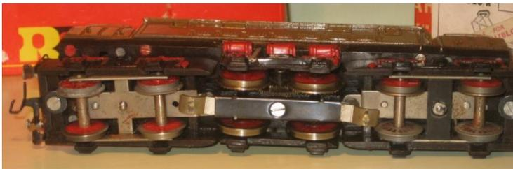
era molto semplice riconvertire il modello in modo che funzionasse a due rotaie togliendo le linguette e invertendo la polarità nel motore e compiendo altre manovre che non sto a riportare.
